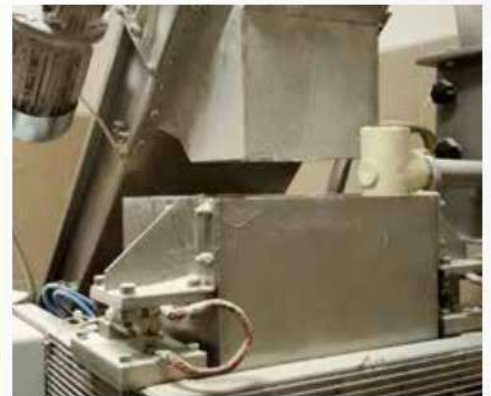
PLA-LIBRA PLUS avec système double de remplissage et micro dosage pour produits en poudre
